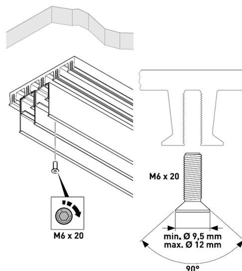
Il profilo di raccordo deve essere fissato al soffitto o alla soffittatura con due sole viti ogni 500 mm, come descritto nelle istruzioni di montaggio della ferramenta Portavant 150 multiline. Per mettere in bolla il profilo di raccordo è possibile anche frapporre degli spessori.
