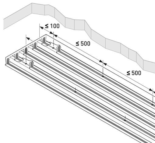
Ad esempio, nei controsoffitti sospesi si può compensare l'eventuale dislivello applicando al soffitto un ulteriore tubo di sezione rettangolare e fissarvi poi il profilo di raccordo. Per poter montare il profilo di raccordo sul tubo di sezione rettangolare è possibile, ad esempio, utilizzare delle viti rapide. A tale scopo sul profilo di raccordo devono essere praticati dei prefori, adatti al diametro delle viti impiegate, all'interno degli appositi solchi che fungono da invito.
