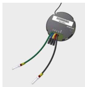
Interfaz de pulsador inalámbrico para instalación empotrada
