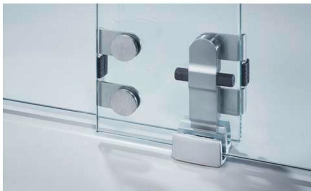
Con Portavant 150 multiline se abren o cierran las hojas correderas simultáneamente con una sola maniobra. Con SOFT CATCH cada hoja corredera sigue a la anterior. Unos amortiguadores integrados en los arrastradores aseguran un arrastre suave y silencioso.
